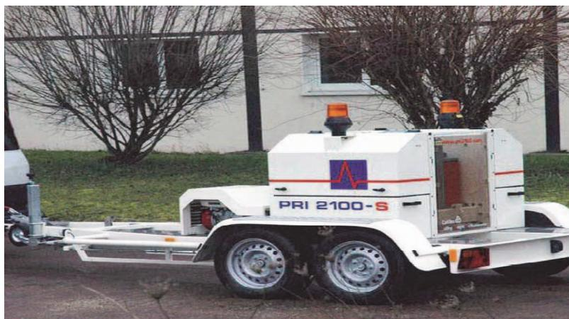
Figure 3. Véhicule de mesure par HWD
